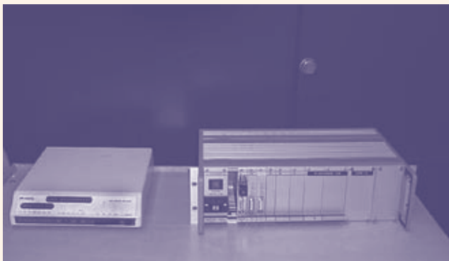
Figuur 4. Een modem en een brug, gebruikt om twee netwerken via een telefoonverbinding te koppelen, omstreeks 1988
