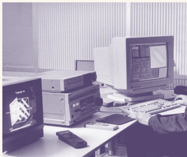
Fig. 3. Apparatuur in het visualisatiecentrum in 1996, met v.l.n.r. de videomonitor, de laser video disk recorder en het beeldscherm van het SGI Crimson workstation, waarop ondermeer een AVS-netwerk staat afgebeeld.
