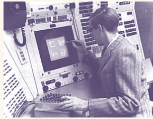
Fig. 9. Pionier Ivan Sutherland (MIT, Boston) in 1963 bezig met een zgn. lichtpen om punten aan te wijzen.
