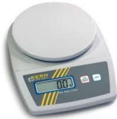
Een eenvoudige balans, nauwkeurigheid: 100 mg beide balansen: www.eurofysica.nl
