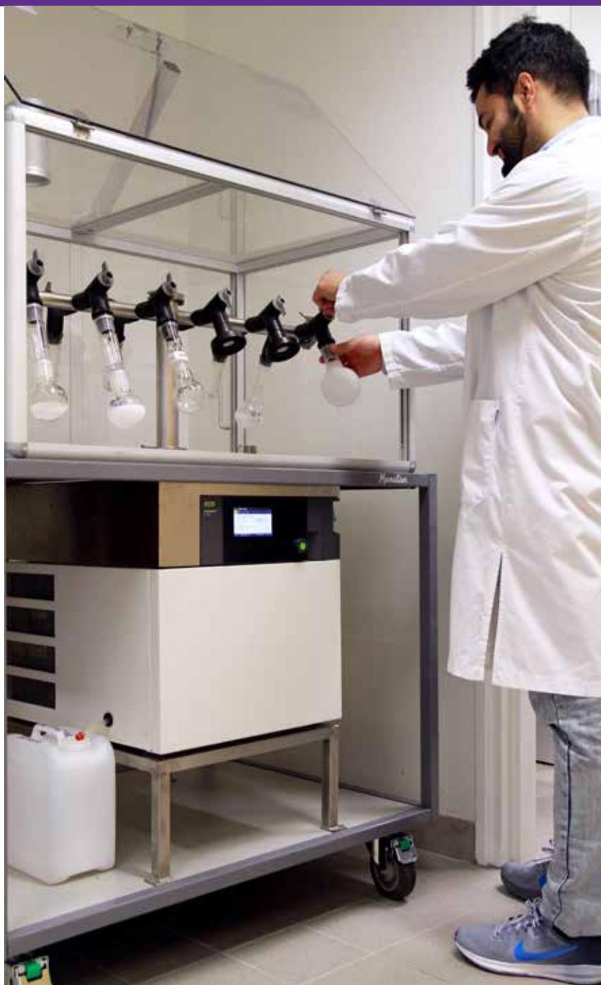
PhD-student Faizan Bhat maakt regelmatig gebruik van de Lyovapor L-200 vriesdroger van Büchi Labortechnik voor het vriesdrogen van kleine peptiden. De vriesdroger is nu ruim een jaar bijna continu, zonder storingen in gebruik.
