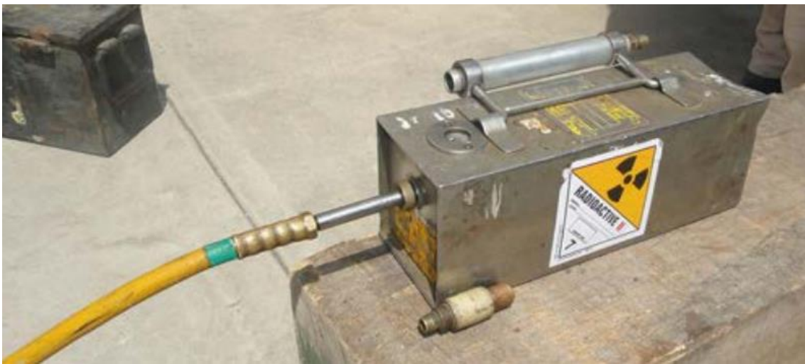
Figuur 4.1 De gebruikte bronhouder met geleideslang
