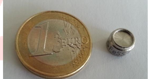
Figuur 1 - ^{55}\text{Fe} -kalibratiebron naast euromuntstuk
