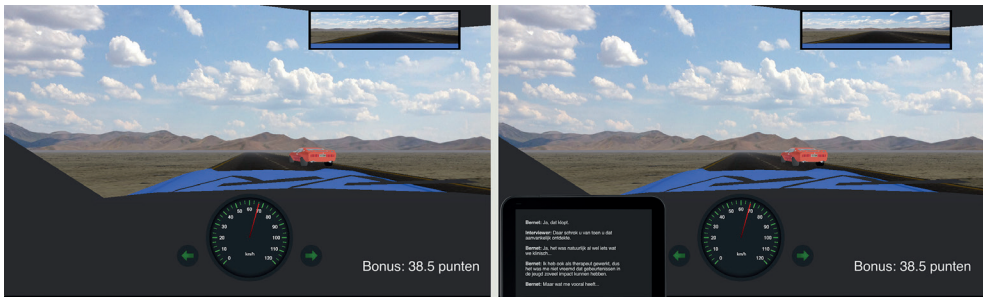
Figuur 7-1. De rij simulator. Links: rijden zonder extra taak. Rechts: rijden terwijl er van een tablet gelezen moet worden.
