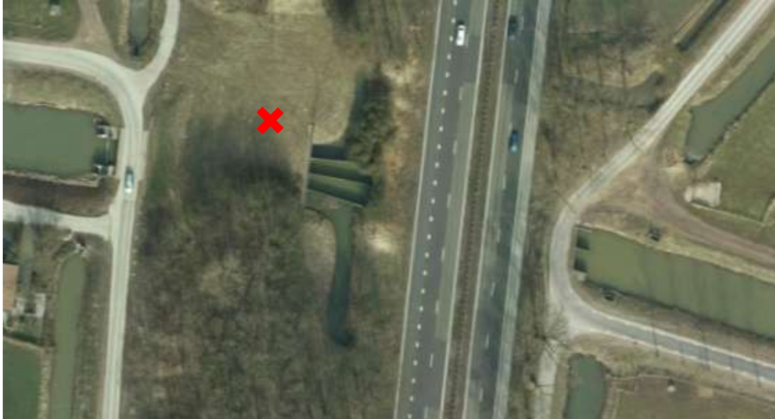
Afb. 26 De huidige kruising van de Defensiedijk en de Linge. De foto van afbeelding 25 is genomen vanaf de plaats van de rode x. Duidelijk zichtbaar is de uit het oosten komende Linge die door een brede duiker onder de snelweg A325 door wordt geleid. Ten westen van de snelweg blijft de Linge in zijn betonnen duiker stromen en zijn links en rechts ervan respectievelijk de Nijslagse zeeg en Broekzeeg naast de Linge gelegd om samen onder de Defensiedijk door geleid te worden. De lengte van de schaduw op het water verraaft dat het peil van de Linge hoger is dan dat van de Broekzeeg, aangezien de vorige afbeelding laat zien dat de drie betonnen wanden even hoog zijn. Ten westen van de dijk bevinden zich drie stuwen, een grote in het midden voor de Linge en twee kleine ernaast voor de zegen. Deze stuwen de wateren niet alleen op tot het gewenste peil maar kunnen ze ook volledig blokkeren wanneer de Defensiedijk zijn functie moest vervullen. Dit is echter nooit gebeurd. Na de opheffing van de IJssellinie in de jaren 1960 is de Defensiedijk op veel plekken afgegraven, zo ook het deel op deze foto. (Bron afbeelding: Google Maps)
